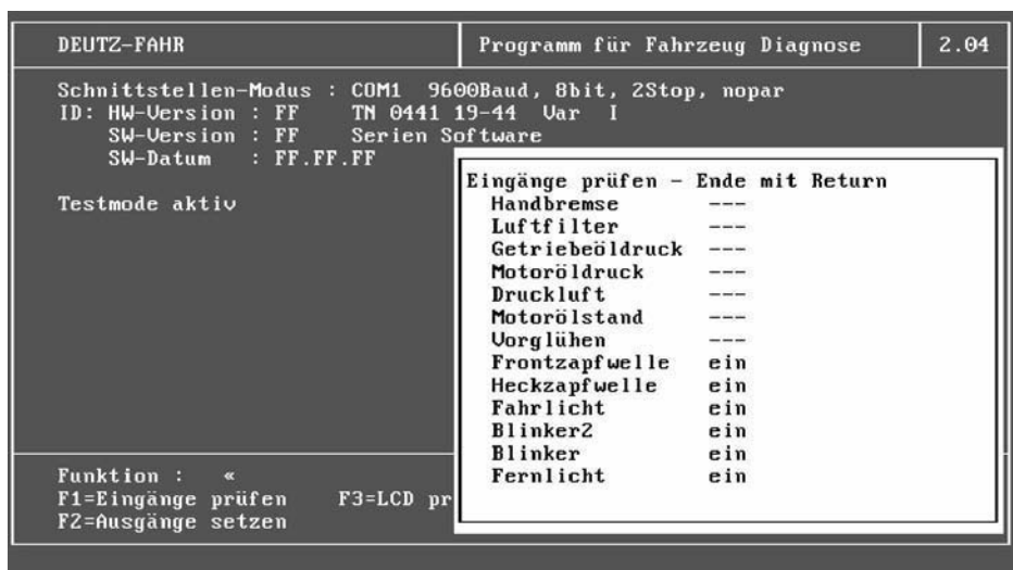
Fig. 56 - Fenêtre Check inputs
